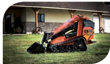
**DITCH WITCH • SK800** - Avec une capacité de chargement de 400 kg à une hauteur maximale de 210 cm, le SK800 permet un chargement productif et la capacité nécessaire pour gérer des tâches lourdes, le tout avec un gabarit compact.
