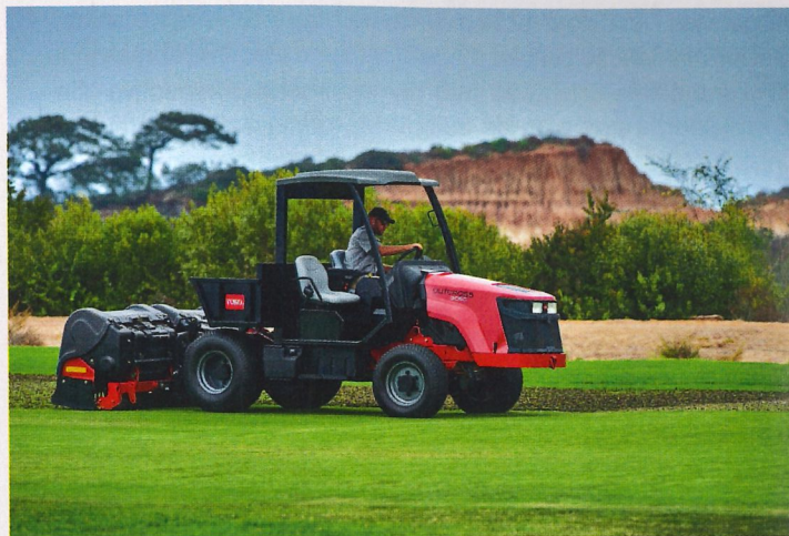
Le Toro Outcross 9060 sera présenté sur le salon. L'engin à quatre roues directrices, entre tracteur et véhicule utilitaire, est motorisé par un Yanmar de 59,8 ch.
